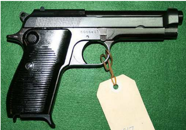
La pistola Beretta modello 951 in calibro 9x19 mm, è stata alla base del progetto che ha portato allo sviluppo della 92FS.
