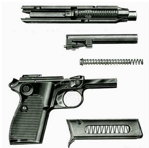
Una interessante vista della pistola modello 951 in smontaggio di campagna. Note lo svincolo tra canna e carrello funzionante a blocchetto oscillante, posizionato sotto la camera di cartuccia della pistola.
