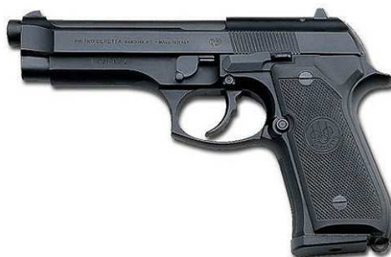
La Beretta 92D è semplicemente una 92FS in sola doppia azione, cioè con il cane che si abbatte automaticamente dopo ogni colpo. Le Beretta 92 in sola doppia azione sono armi nate per soddisfare le diverse esigenze di servizio delle forze di Polizia americane. Il cane è esterno, ma la sua cresta è stata tagliata a filo con il carrello. Manca la sicura manuale, che è presente sul modello 92 DS.
