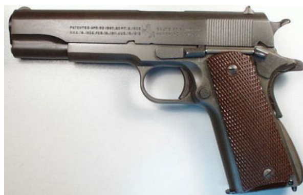
La Colt 1911-A1, entrata in servizio nel 1926, presenta delle leggere migliorie ergonomiche, rispetto al modello del 1911. L'organizzazione meccanica interna, rimane però invariata.
