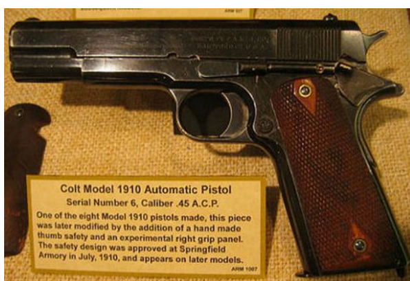
Un altro esemplare di Colt 1910. Notate che su questa pistola è presente la sicura manuale, assente nella precedente. Di questa pistola intermedia ne furono prodotti solo 12 esemplari dal Luglio 1910 al Settembre 1911. Questo tipo di prototipi, come quelli modello 1909, venivano spediti ai vari graduati che si occupavano delle prove, rispediti in fabbrica dove venivano sottoposti a modifiche, e quindi spediti nuovamente ad altri ufficiali per altre prove. Per questo motivo è possibile trovare modelli con numero di serie più basso, ma dotati di dispositivi meccanici sviluppati successivamente alla loro produzione.
