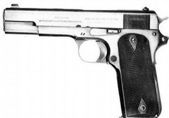
Il modello del 1909; per la prima volta appare la boccola in volata. Il fusto però, è chiaramente derivato dal modello del 1907, come si può notare dall'inclinazione dell'impugnatura, ancora praticamente verticale.
