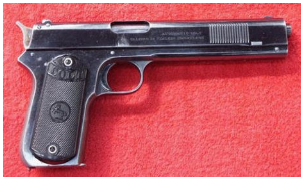
La Colt modello 1900, fu la prima pistola automatica a chiusura stabile prodotta da Colt. Il calibro era il 38 ACP, che era ritenuto troppo piccolo dall'Esercito Americano.
