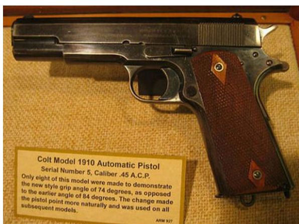
Il modello 1910, che partecipò alle prove del 1910. A stento si riconosce la vecchia pistola del 1907. L'impugnatura non è più dritta, ma inclinata come sarà nel modello definitivo.
