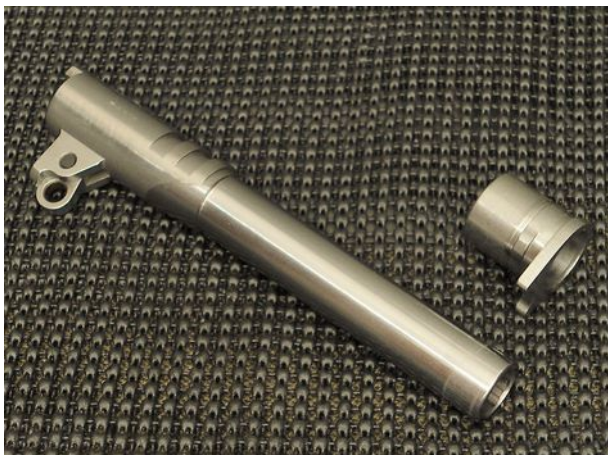
La pistola monta canna e boccola di volata di tipo match. Notare i segni lasciati dal bushing sulla volata della canna.
