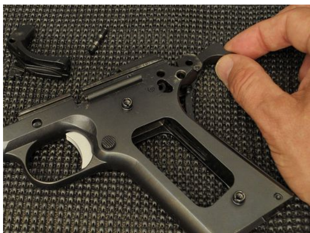
Sfilando il perno da dietro leviamo il cane, e in questo caso anche la levetta della sicura al percussore.
