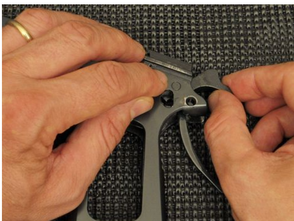
Il foro del cane va allineato al foro sul fusto, e quindi si inserisce il perno.
