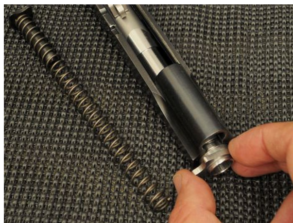
Canna e boccola match si separano solo facendo avanzare leggermente la canna.
