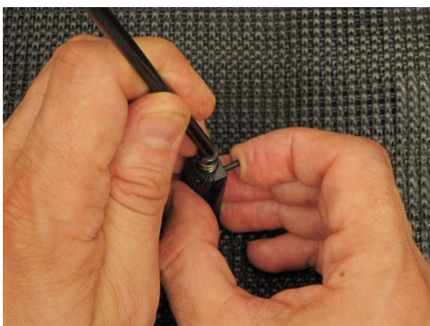
Il rimontaggio della mainspring house.
