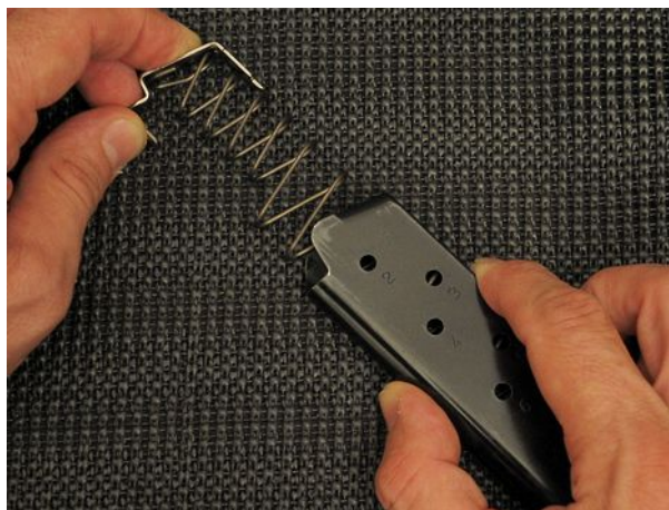
Infiliamo la molla all'interno del caricatore e appoggiamo l'elevatore nella posizione corretta.
