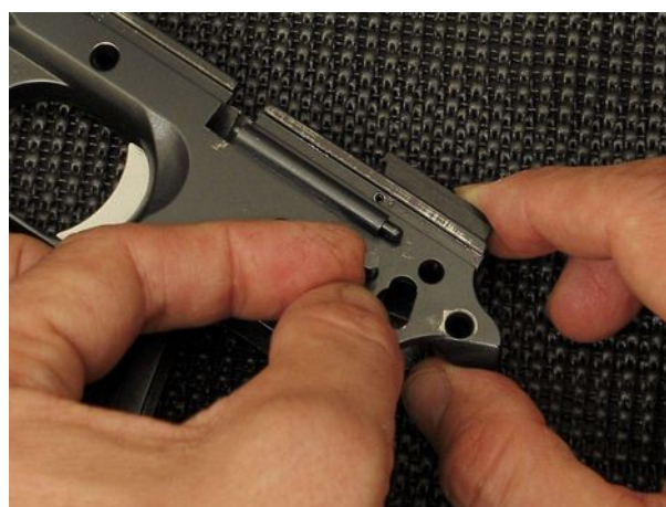
Se la pistola è una serie 80, non inserite il perno completamente. Dovrete ancora posizionare una delle due leve della sicura automatica.
