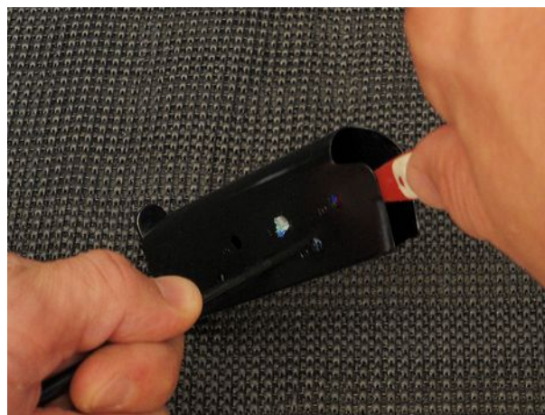
Usiamo lo spazzolino di pulizia e un pennello per smontare il caricatore.
