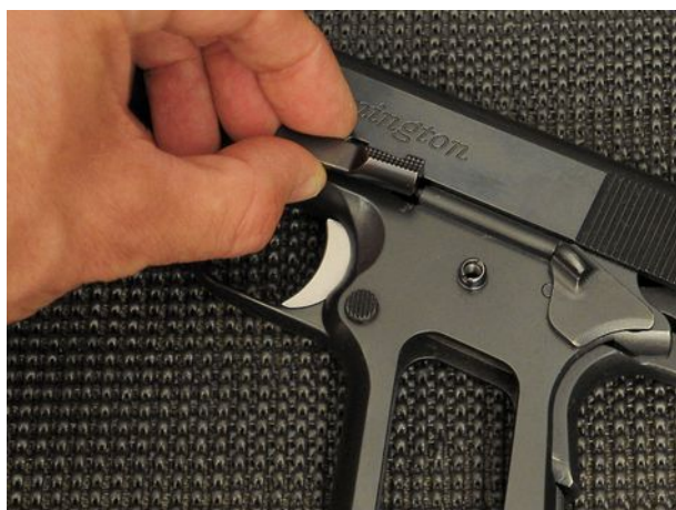
Facciamo forza sul perno che fuoriesce dal fusto dalla parte opposta, per estrarre la leva dello slide-stop.
