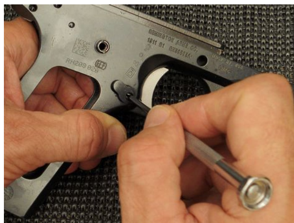
La testa del perno dotata di intaglio va ruotata con un cacciavite. Il pulsante di sgancio deve essere premuto.
