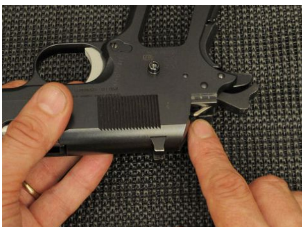
Se il carrello non procede, non spingete con forza. Controllate che la leva della sicura automatica al percussore non si sia sollevate per errore.
