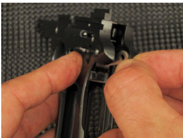
La punta più corta della prima leva della sicura automatica deve essere rivolta verso di noi. La punta più lunga, verso il basso.
