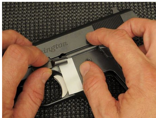
Alcuni non riescono ad inserire la leva dello slidestop senza graffiare fusto o carrello. Possiamo proteggere il fusto con una striscia di nastro adesivo, per evitare di fare danni.
