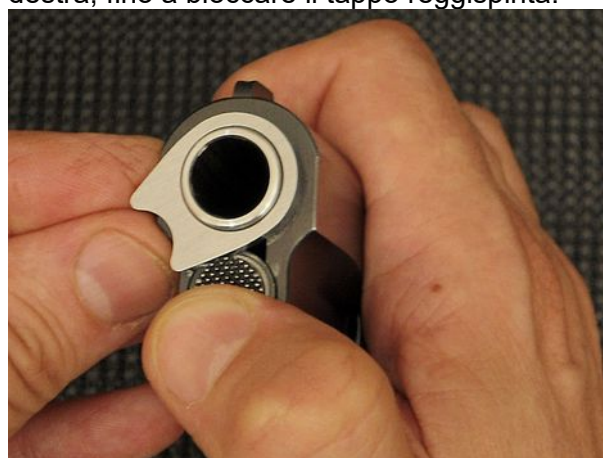
Per ruotare il bushing è spesso necessario aiutarsi con l'apposita chiave.
