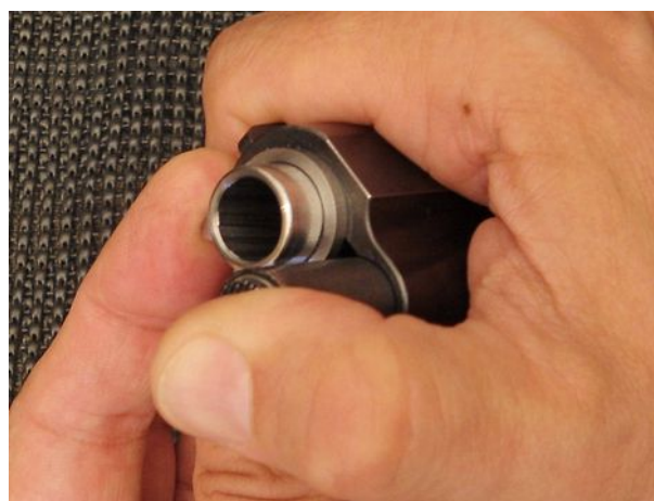
Il bushing va ruotato verso sinistra per svincolare il tappo reggispinta. Io non uso la chiave, ma su questa pistola è necessaria. Chi ha occhio clinico probabilmente ha già capito il trucco.
