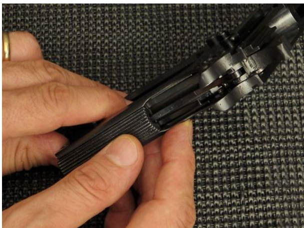
Il puntone del cane deve andare ad inserirsi all'interno del bottone superiore del dorsalino porta molla.
