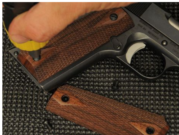
Per evitare di intaccare le viti delle guance, utilizziamo un cacciavite di misura adeguata.
